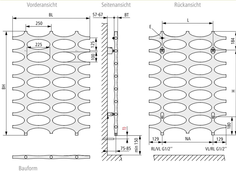
Abstand Unterkante Heizkörper zu Boden min. 150 mm.
