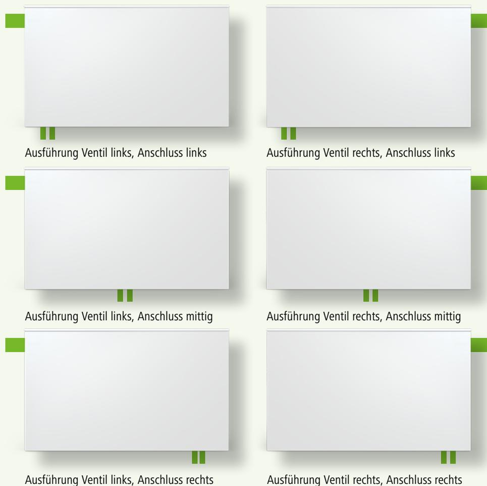
Der therm-x2 Vmulti Universalheizkörper bringt die Flexibilität bei der Montage auf ein neues Niveau. Insgesamt **sechs Anschlussmöglichkeiten** stehen zur Verfügung: **drei Anschlusspositionen unten und zwei Ventilpositionen.**
