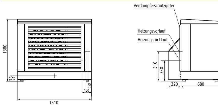
Das dargestellte Zubehör (Anschlussabdeckung, Kondensatauffangwanne, Verdampferschutzgitter) ist nicht Bestandteil der Wärmepumpe -> Zubehör
