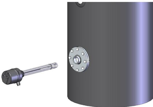
4. Montieren Sie den Temperaturfühler auf Position C (Rp ½) (siehe Montageanleitung x-buffer® fresh Warmwasserspeicher).
