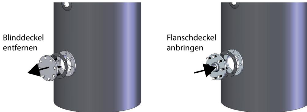
2. Verschrauben Sie den Flanschdeckel mit der vorhandenen Flanschdichtung und den Schrauben dicht am x-buffer® fresh Warmwasserspeicher. Achten Sie darauf, dass Sie die Flanschdichtung nicht beschädigen.
