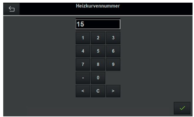
Abb. 25: Auswahl der Heizkurvennummer
