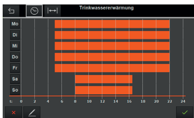
Abb. 7: Bearbeitung von Zeitprogrammen -> Erstellung von Zeitblöcken
