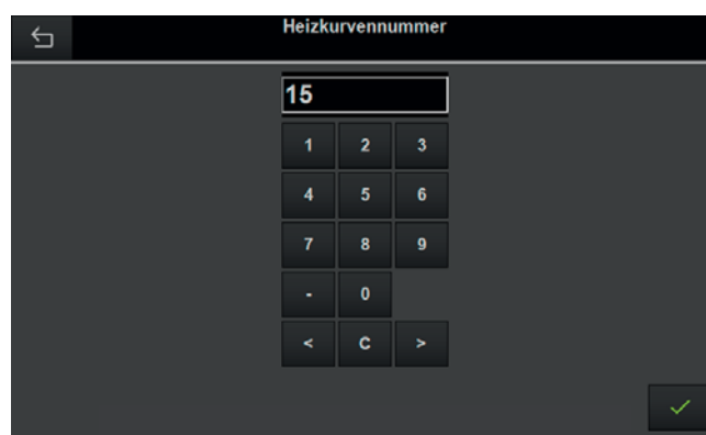
Abb. 37: Auswahl der Heizkurvennummer
