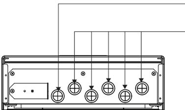
Loch A: Für die Gleichstromleitung (das Kabel, das mit den Leiterplatten des Kontrollkastens verbunden ist)
