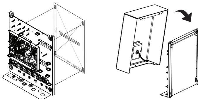
**Step 7.** Decken Sie die Frontabdeckung ab, setzen Sie den Verbindungsstecker der Fernbedienung zusammen, schließen Sie die Abdeckung der Halterung und markieren Sie die vier Schraubenbolzen darunter. Um zu verhindern, dass der Kabelbaum der Fernbedienung eingeklemmt wird, legen Sie ihn vor dem Einbau in die Platte oder die vordere Abdeckung.
