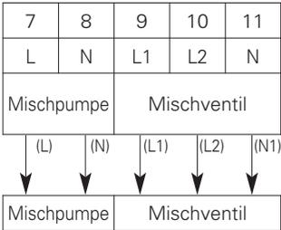
(L) : Spannung von der Platine zur Mischerkreispumpe.
