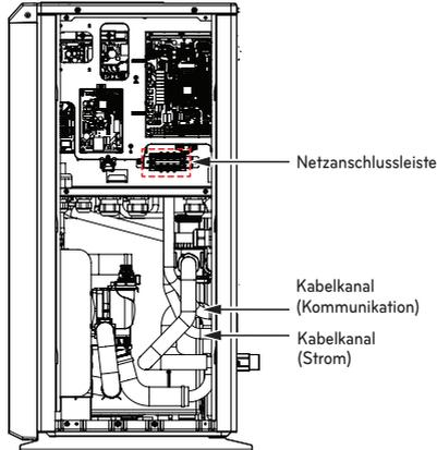
**Schritt 2.** Verbinden Sie das Netzkabel mit der Hauptnetzklammer
