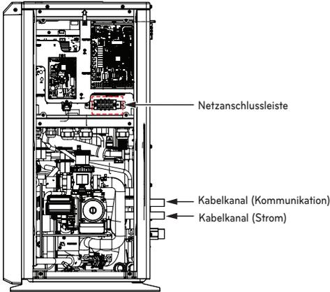
**Schritt 2.** Verbinden Sie das Netzkabel mit der Hauptnetzklammer
