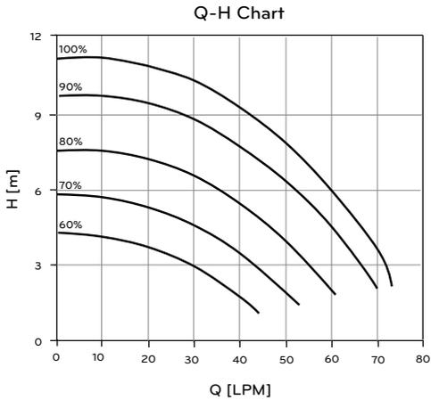
Leistungstest basiert auf Standard ISO 9906 mit Vordruck 2.0 bar und Flüssigkeitstemperatur 20 °C.
