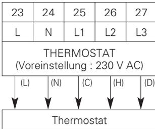
(L) : Spannung von der Platine zum Thermostat
