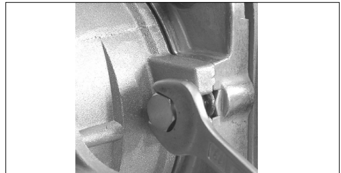
Abb. 4.7: Schnellverschluss 90° gedreht - geschlossen
