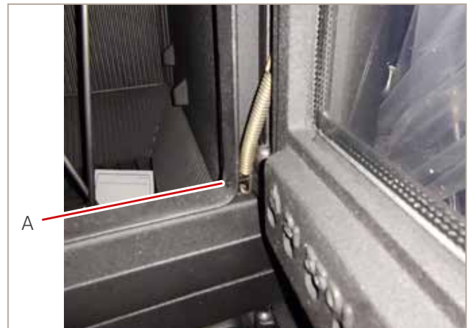
Abb. 16: Befestigungsschraube Zugfeder lösen
