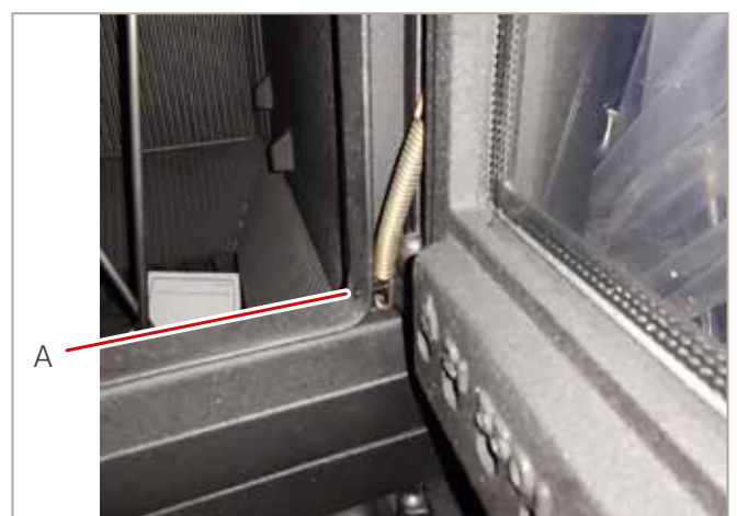
Abb. 17: Befestigungsschraube Zugfeder eindrehen
