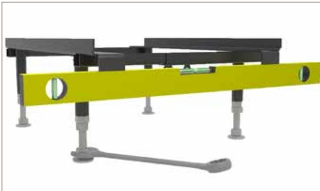
Abb. 26: Heizeinsatz ausrichten
