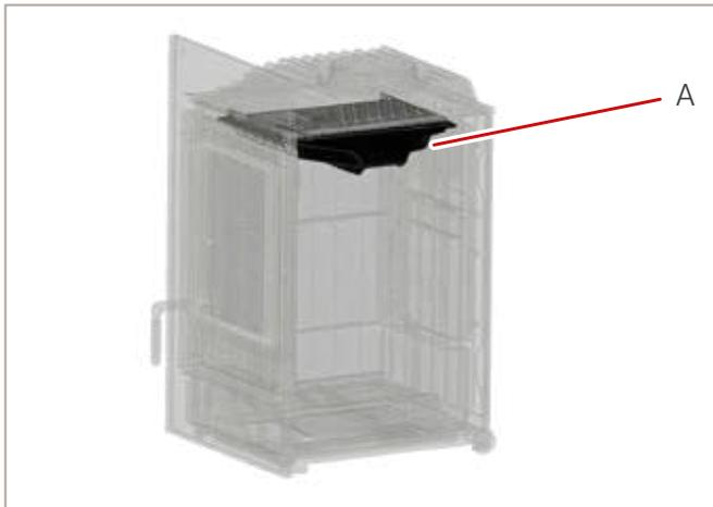
Abb. 29: Heizeinsatz mit Guss-Umrüstrahmen
