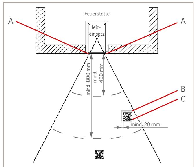
Abb. 52: Schutz von brennbaren Bauteilen im Strahlungsbereich vor der Feuerraumöffnung, Schema
