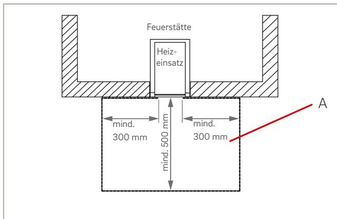
Abb. 51: Belag aus nicht brennbaren Baustoffen im Bereich vor der Feuerraumöffnung, Schema
