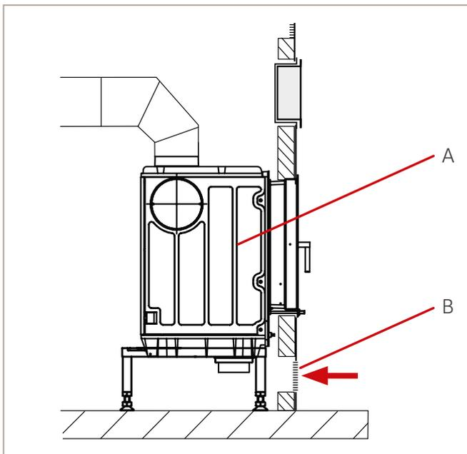
Abb. 7: Beispiel: Verbrennungsluftzufuhr aus dem Aufstellraum
