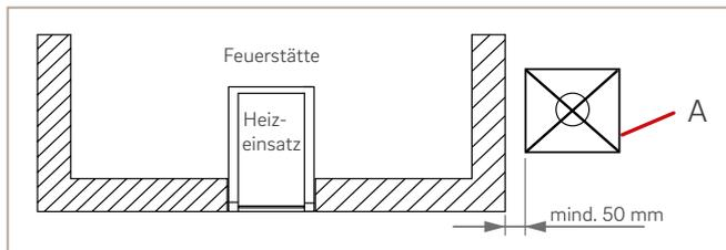
Abb. 53: Schutz und Abstände bei beheizten Flächen, Schema
