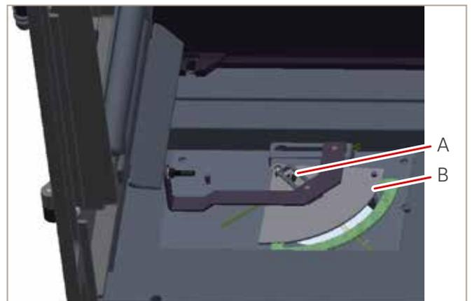
Abb. 46: Befestigungsschraube lösen
