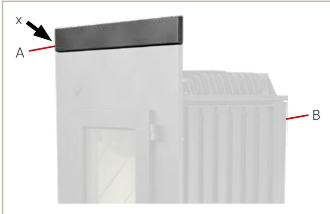
Abb. 47: Heizeinsatz mit Frontplatten-Erweiterung
