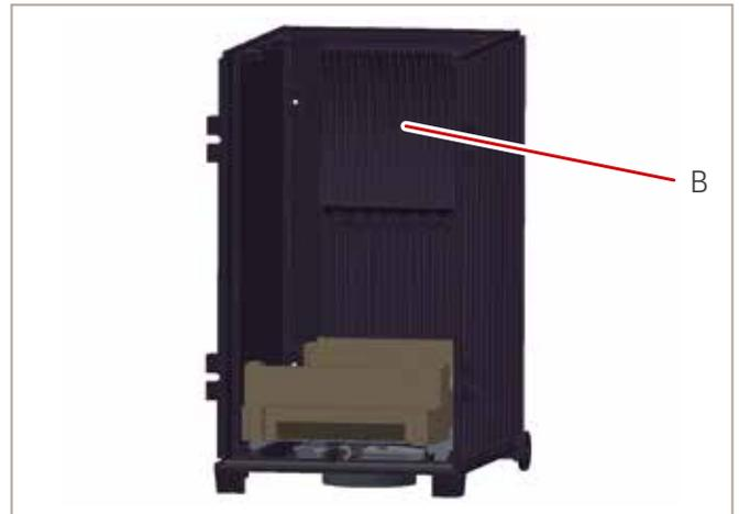
Abb.23: Sekundärbelüftung mit Befestigungsschraube demontieren (Front ausgeblendet)
