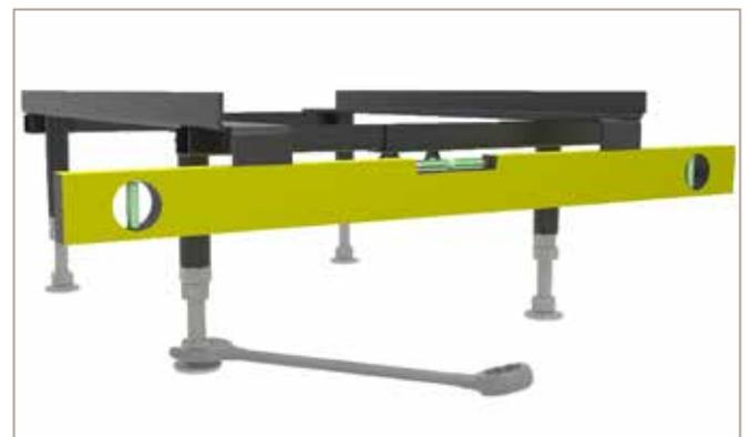
Abb. 5: Heizeinsatz ausrichten
