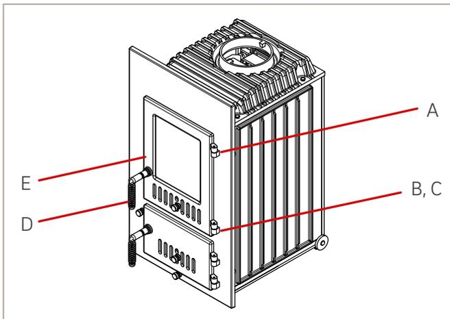
Abb. 30: Fülltür ausbauen und einbauen
