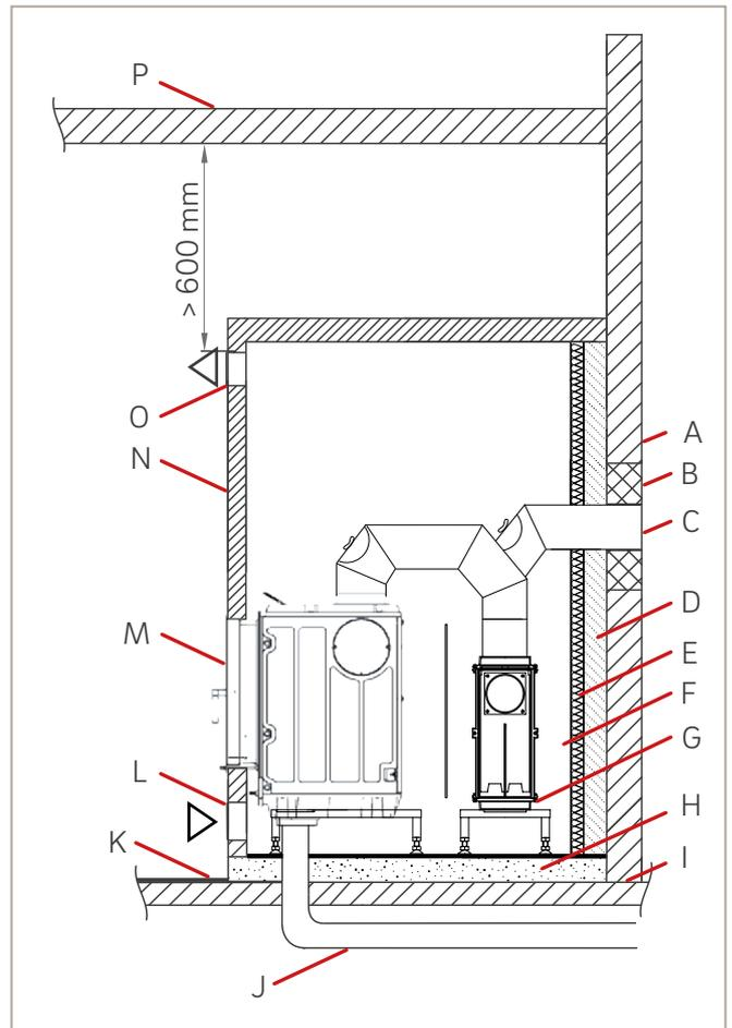
Abb. 50: Einbaubeispiel für einen Heizeinsatz mit Nachheizkasten vor zu schützenden Wänden, Böden, Decken
