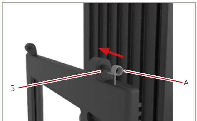
Abb. 33: Feder in Bohrung einsetzen
