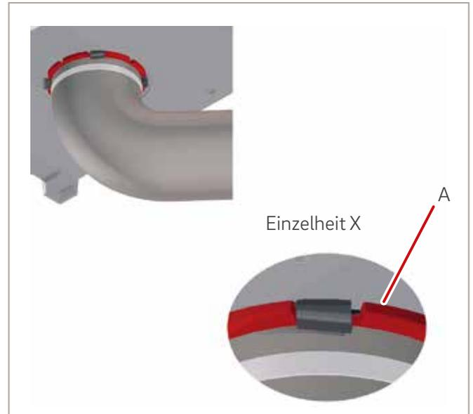
Abb. 10: Verbrennungsluftstutzen aufstecken
