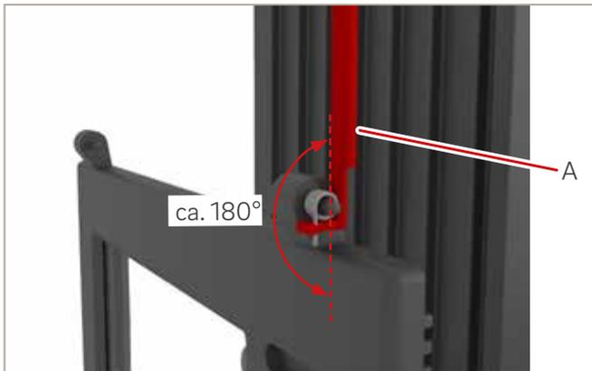
Abb. 34: Spanschlüssel ansetzen
