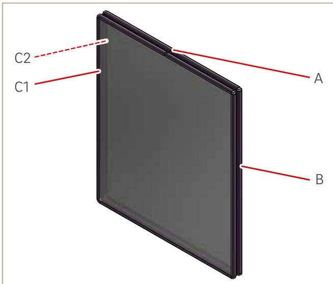
Abb. 42: Halterahmen Doppelverglasung
