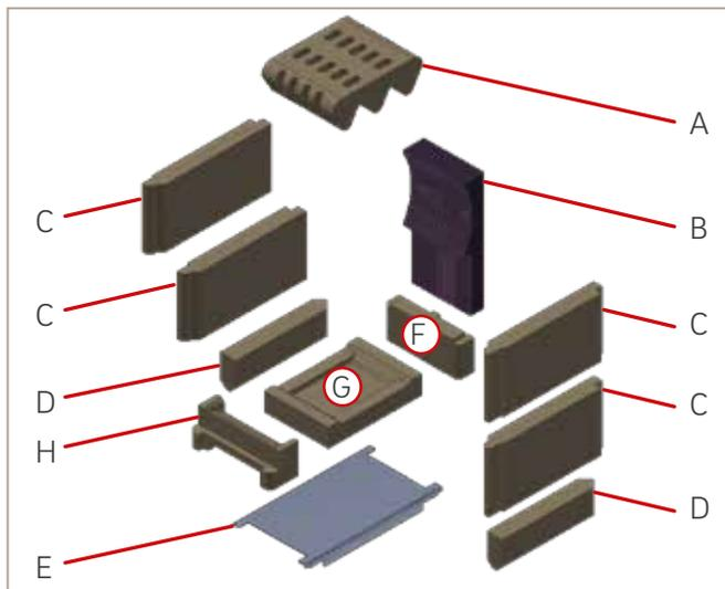
Abb. 19: Zusammenbau Innenauskleidung
