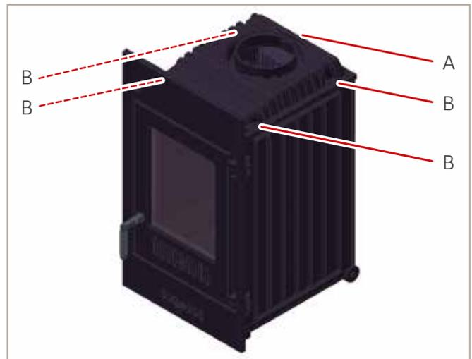
Abb. 18: Kuppel demontieren (ohne Seitensteine)
