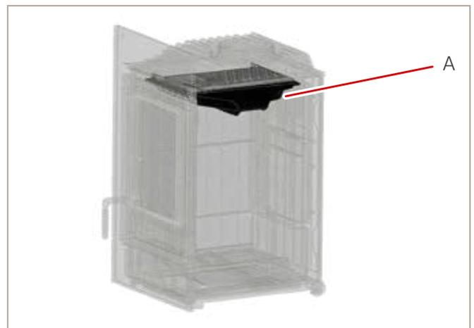
Abb. 34: Heizeinsatz mit Guss-Umrüstrahmen - am Beispiel SH 9 D
