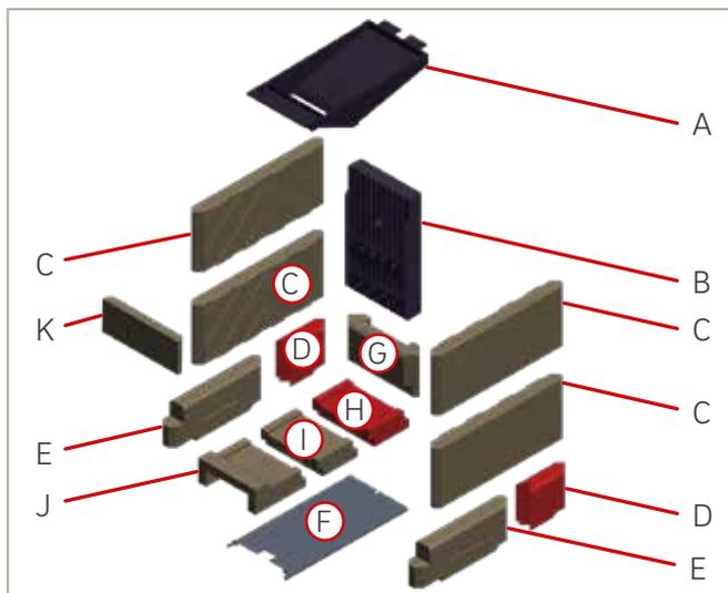
Abb. 23: Zusammenbau Innenauskleidung am Beispiel SH 11 G
