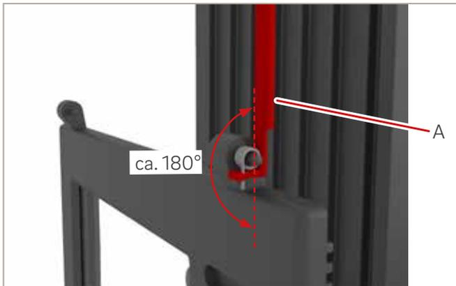
Abb. 39: Spannschlüssel ansetzen
