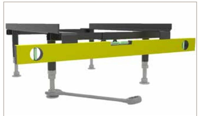
Abb. 6: Heizeinsatz ausrichten
