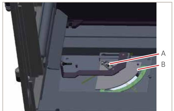
Abb. 51: Befestigungsschraube lösen
