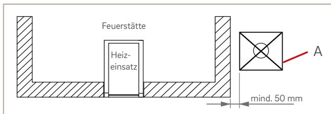
Abb. 58: Schutz und Abstände bei beheizten Flächen, Schema
