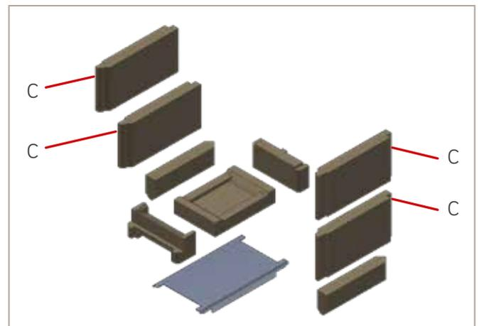
Abb. 21: Ausbau Bauteile C
