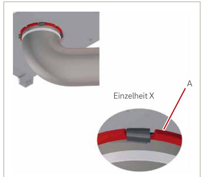
Abb. 11: Verbrennungsluftstutzen aufstecken
