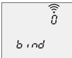
Abb. 8: Verbindungsmenü (kein Lüftungsgerät verbunden)
