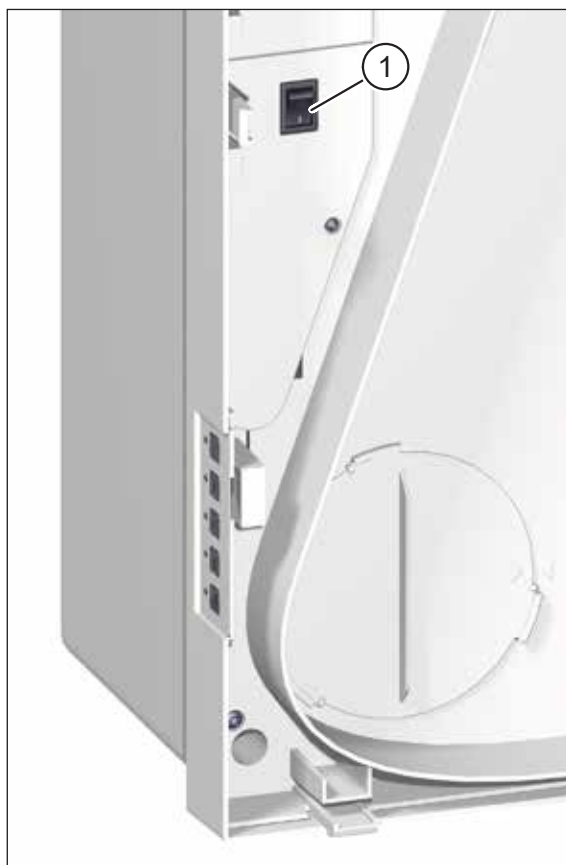
Abb. 13: Netzschalter, sichtbar nach Abnahme des Gerätedeckels
