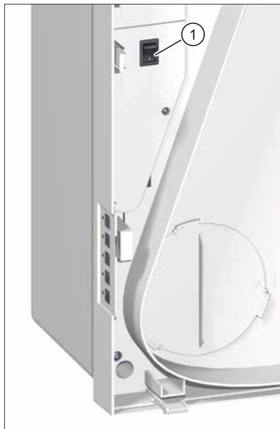
Abb. 14: Netzschalter, sichtbar nach Abnahme des Gerätedeckels
