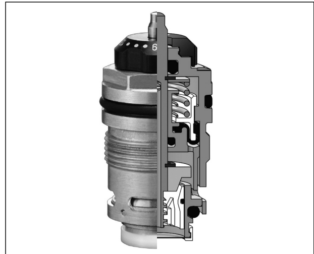
Vereinfachte Darstellung des Ventileinsatzes mit „Q-Tech“
