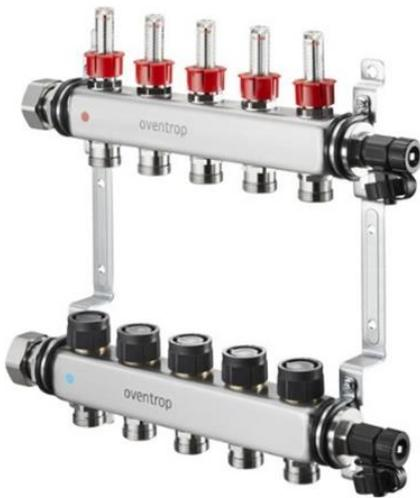
Der Multidis SF ist ein Heizkreisverteiler, der für eine optimale Wärmeverteilung der einzelnen Heizkreise sorgt. In Verbindung mit einem Raumthermostaten und einem Stellantrieb erfolgt eine effiziente Regulierung der benötigten Durchflussmenge. Der statische hydraulische Abgleich kann mittels der integrierten Durchfluss-, Mess- und Reguliereinsätze durchgeführt werden. So wird eine optimale Wärmeverteilung erreicht und dadurch die Heizkosten reduziert.
