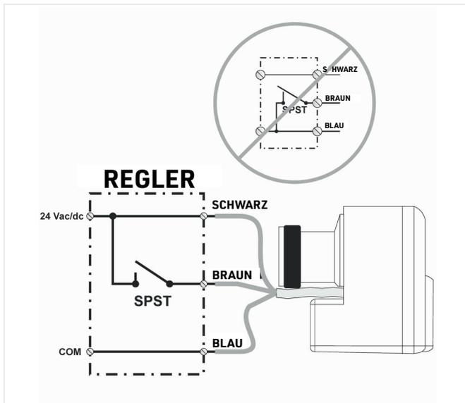
Abb. 2 Elektrische Verdrahtung M5410C1001
