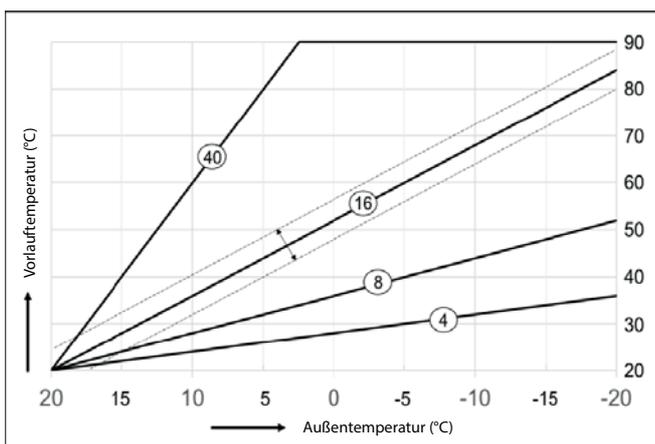
Abb. 1 Diagramm des Außentemperatursausgleichs
