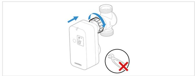
Abb. 3 Stellantrieb montieren
