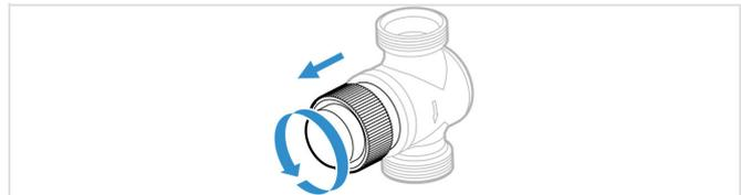
Abb. 2 Schutzkappe entfernen
