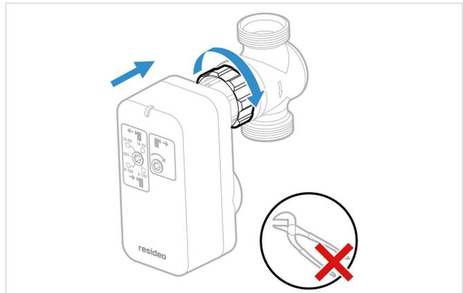
Abb. 3 Stellantrieb montieren
