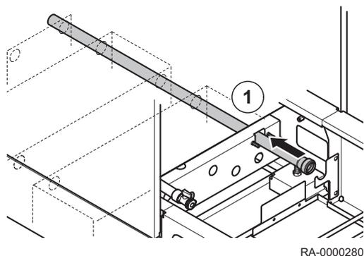
Nach dem Aufstellen und Ausrichten des Kessels sind der Siphon und die Kondenswasserleitungen zu montieren.
