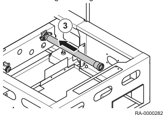
3. Langes gerades Rohrstück bis zum Anschlag in das vordere Ende der Kondenswasserleitung stecken.
