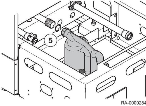
5. Siphon mit beiliegender Dichtung am zuvor montierten Siphonadapter anschrauben.
