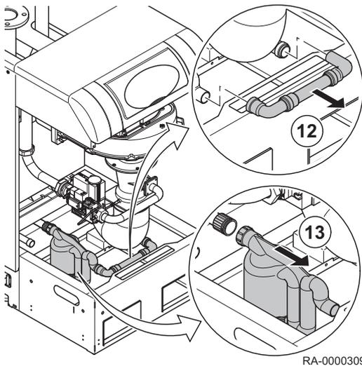
12. Rohrverbindung entfernen
