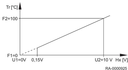
Abb.55 Beispiel für zwei unterschiedliche Fühlerkennlinien
