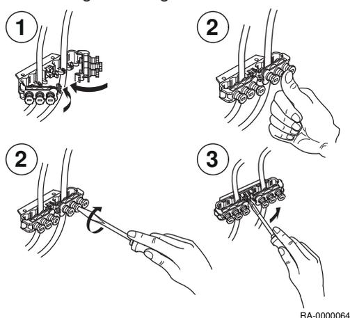
Alle elektr. Leitungen sind in den Zugentlastungen des Schaltfeldes festzusetzen und entsprechend dem Schaltplan anzuschließen.
