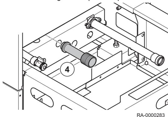
4. Siphonadapter in das Gewinde der Kondensatwanne einschrauben.
