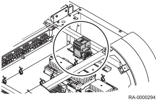
Das Pumpenhilfsschutz PHS dient zum Betrieb von Drehstrompumpen oder einphasigen Pumpen mit einer Stromstärke von mehr als 1 A und befindet sich unter dem vorderen Verkleidungsdeckel auf der rechten Seite.
