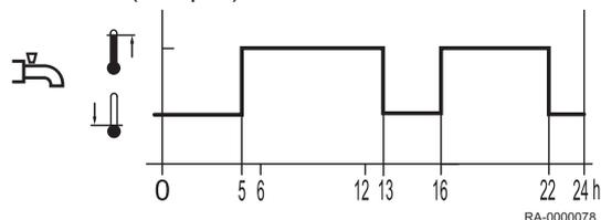
Zeitprogramm 4/TWW: Die Trinkwassertemperatur wird unabhängig von den Zeitprogrammen der Heizkreise zwischen dem Trinkwassertemperatur-Sollwert und dem Trinkwassertemperatur-Reduziertersollwert umgeschaltet. Dabei wird das Zeitprogramm 4 genutzt.
