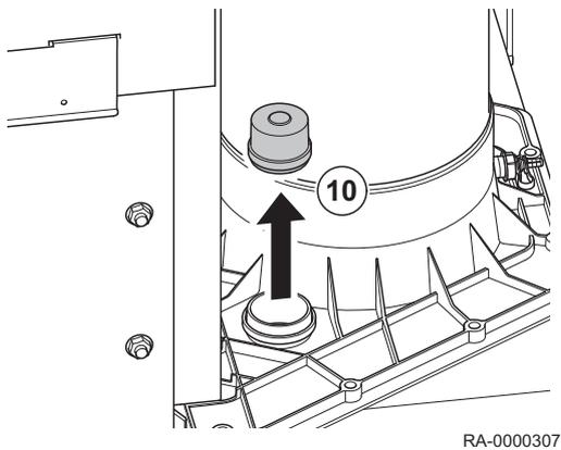
10. Verschlusskappe der Kondensatwanne entfernen
