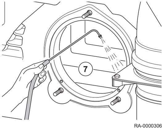
7. Wärmetauscher durch die Brenneröffnung von innen mit Gaskessel-Reinigungsmittel besprühen
