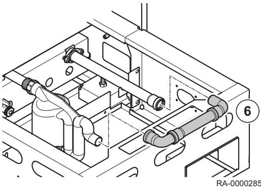
6. Restliche Rohrstücke gemäß Abb. zusammenstecken und montieren.
