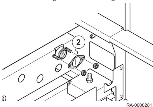
2. Kondenswasserleitung mit Rohrfixierung befestigen.
