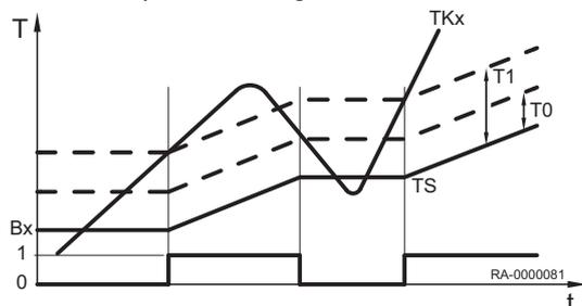
Für die Inbetriebnahme der Pumpe ist eine ausreichend große Temperaturdifferenz zwischen der Kesseltemperatur und der Vergleichstemperatur notwendig.
