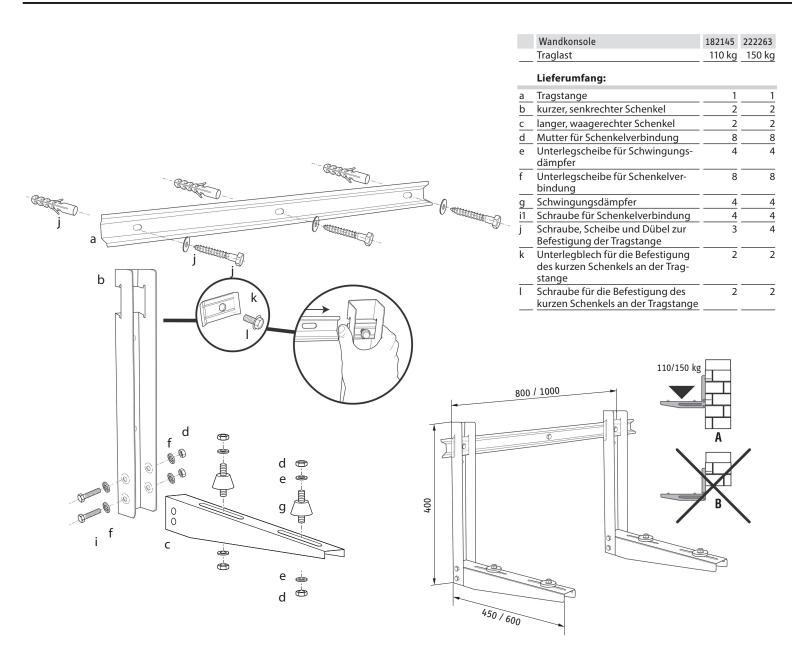
Bevor Sie die Tragstange mit den Konsolen an der Wand befestigen, müssen Sie sicherstellen, dass die Wandstruktur die Gewichtskräfte der Außeneinheit tragen kann. Die beiliegenden Dübel dürfen nur bei massiven Wänden verwendet werden. Bei anderen Wandstrukturen müssen Sie geeignete Wandbefestigungen wählen.
