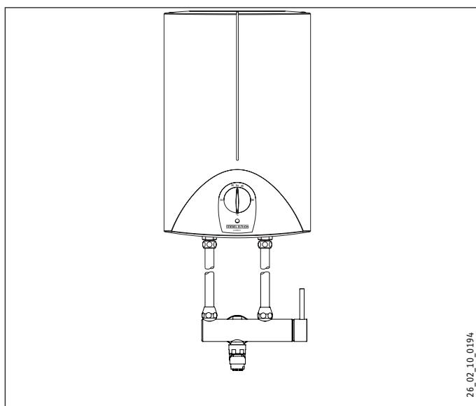
► Spojte zásobník a tělo baterie přišroubováním přítokového vodovodního potrubí.
