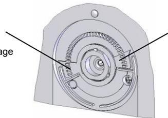
Einstellfahne für maximalen Temperaturwert
