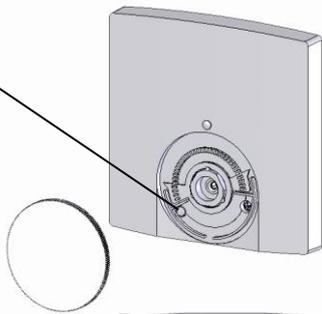
Lerntaste bei geöffnetem Gehäuse
