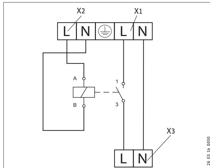
X1 Netaansluiting L, N, PE
