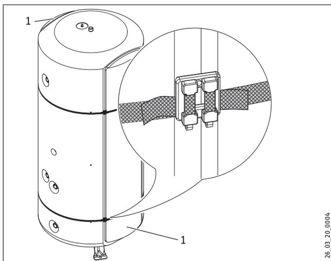
1 seitliches Wärmedämmsegment
