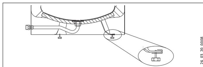
► È possibile compensare con i piedini regolabili le irregolarità del pavimento.
