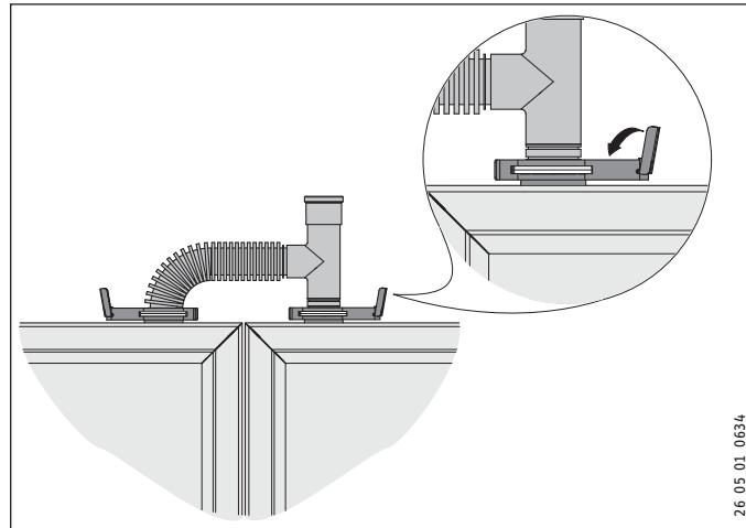
Pour raccorder les capteurs solaires, utilisez le raccord à emboîter SV-I (voir Accessoires requis).
