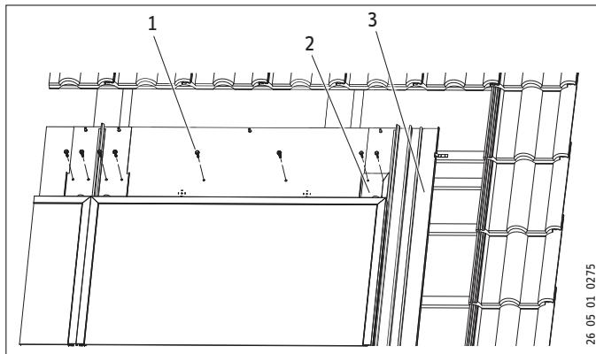
1 Vite di fissaggio con guarnizione
