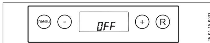
Wenn das Gerät softwaremäßig ausgeschaltet wurde, wird im Display „OFF“ angezeigt.
