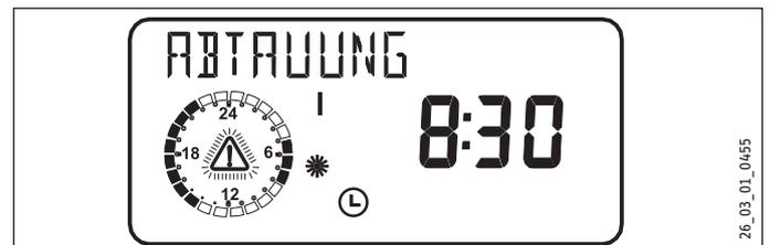
Wenn das  $\Delta$ -Symbol blinkt, aber kein Fehlercode im Display erscheint, hat der Verdichter wegen eines Fehlers beim Abtauen abgeschaltet (siehe Parameter *VERDAMPFER-MIN*).
