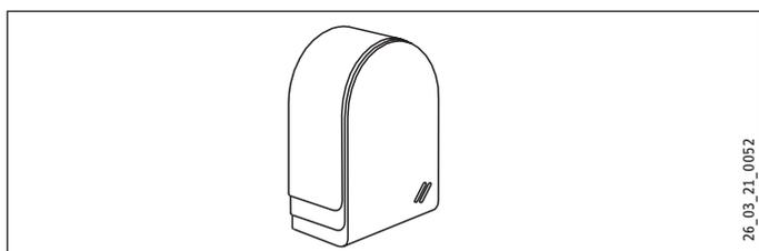
Der Außentemperaturfühler soll der Witterung frei und ungeschützt ausgesetzt sein. Er darf nicht über Fenster, Türen und Licht- oder Luftschächte montiert werden und soll nicht der direkten Sonneneinstrahlung ausgesetzt sein. Bringen Sie den Außenfühler an einer Nord- oder Nordostwand an.
