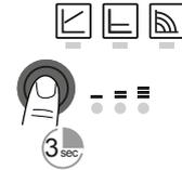
Wenn die Pumpe nicht selbsttätig entlüftet: Entlüftungsfunktion über die Bedientaste aktivieren: 3 Sekunden drücken, dann loslassen. Entlüftungsfunktion startet (Dauer 10 Minuten). Die oberen und unteren LED-Reihen blinken abwechselnd im Sekundentakt.
