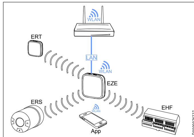
Mit dem EASYTRON Connect System wird die Einzelraumregelung von Heizungssystemen in Gebäuden realisiert. Das System kann über das ISG web mit einer Wärmepumpe verbunden werden oder autark arbeiten. Wenn das System mit einer Wärmepumpe verbunden ist, ist eine Einzelraumregelung mit Bedarfsanforderung möglich. Die Bedienung kann über die EASYTRON Connect App erfolgen.
