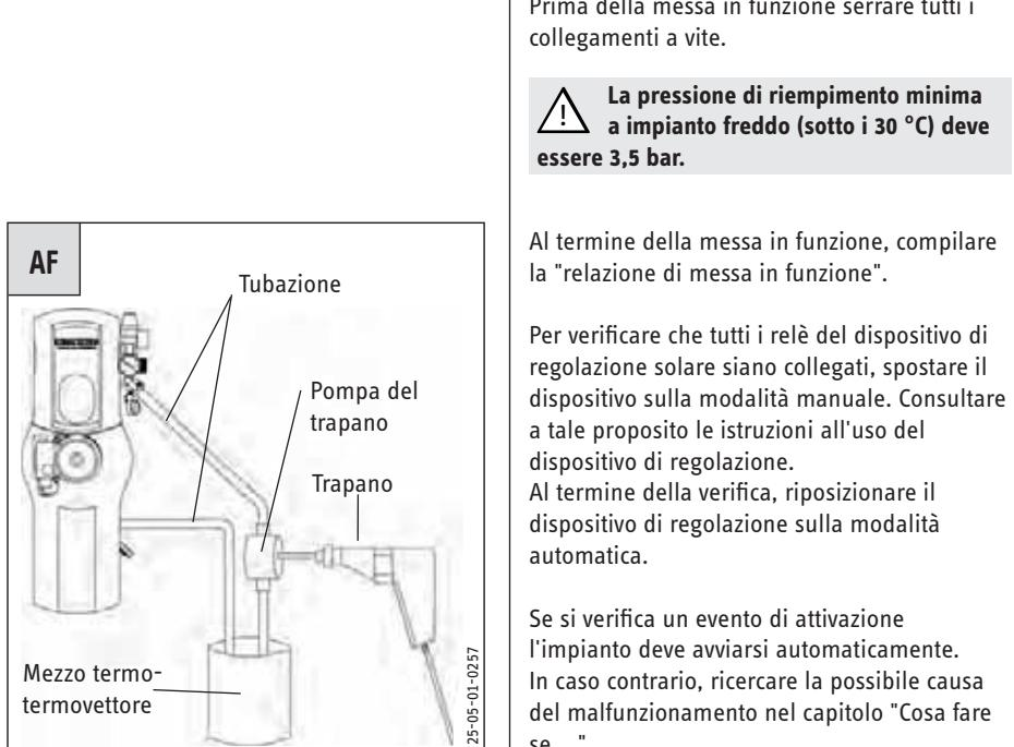
**Lo scarico della valvola di sicurezza deve defluire secondo norma DIN 4757 in una vaschetta di raccolta in grado di ricevere l'intero contenuto dell'impianto. Negli impianti minori è sufficiente la tanica del termovettore svuotata.**
