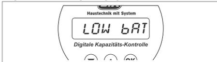
Um die Batterie zu tauschen, schrauben Sie den Deckel ab und ersetzen Sie die Batterie (CR-2450). **Achten Sie auf die richtige Polarität!**
