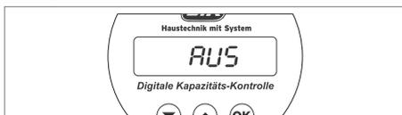
Bei aktivierter Leitwertüberwachung können Sie einen Grenzwert von 10 - 200  $\mu\text{S}$  einstellen.
