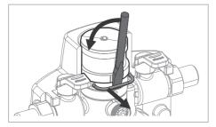
Hebeln Sie mit einem Schraubendreher das Manometer heraus.
