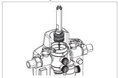
Ziehen Sie die Patrone unter leichtem Drehen heraus und reinigen Sie ggfs. die Patrone mit klarem Trinkwasser.
