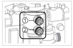
Montieren Sie die Wartungskugelhähne an Stelle der Manostopfen.
