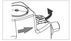
Wenn aus dem Ablauftrichter Wasser tropft, liegt ein mechanischer Defekt oder eine Verschmutzung des Ausgangsrückflussverhinderers vor.
