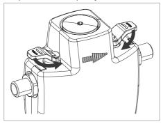
Öffnen Sie das Nadelventil 1 und lassen Sie über das Nadelventil 1 langsam den Druck ab (wenige Tropfen).
