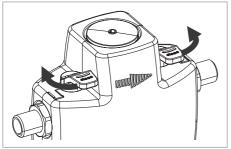
Schließen Sie nach Beendigung des Füllvorgangs die beiden Absperrungern, um eine unkontrollierte Nachbefüllung zu vermeiden.
