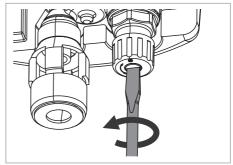
Drehen Sie zur Senkung des Fülldrucks den Einstellgriff in Richtung Minus (-) und zur Erhöhung in Richtung Plus (+).
