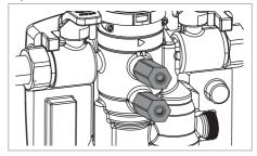
Montieren Sie die Nadelventile des Messgerätes (z.B. 6600.00.000) an die Wartungskugelhähne 1 + 2.
