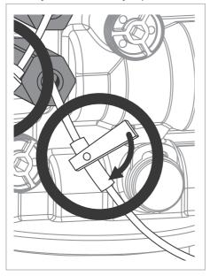
Schließen Sie das Nadelventil wieder. Beobachten Sie den Ablauftrichter. Der Differenzdruck muss über 140mbar liegen und der Eingangsrückflussverhinderer (RVI) muss wieder völlig schließen, ansonsten liegt eine Verschmutzung oder ein mechanischer Defekt vor.
