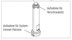
Setzen Sie das Werkzeug von oben auf die Systemtrenner-Patrone (1) und drehen Sie im Uhrzeigersinn (2).
