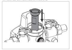
Achten Sie darauf, dass die Aussparungen des Werkszeugs in die Zapfen des RV 2 greifen.
