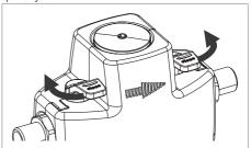
Entlüften Sie die Armatur über die beiden Nadelventile. Schließen Sie die beiden Nadelventile anschließend wieder.
