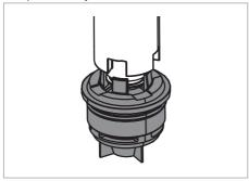
Entfernen Sie den RV 2, in dem Sie ihn gegen den Uhrzeigersinn herausdrehen
