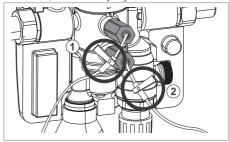
Montieren Sie das Messgerät und öffnen Sie die beiden Absperrungen.
