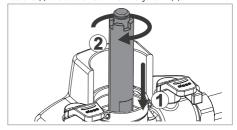
Achten Sie darauf, dass die beiden Zapfen des Werkzeugs in die Laschen der Patrone greifen.
