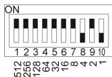
Ilustracja 23: Przełącznik kodujący adres PROFIsafe (ustawienie „1018”)
