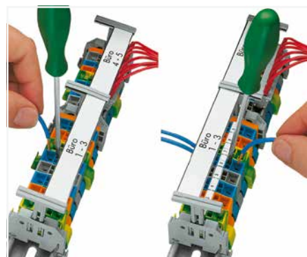
Das seitlich verschiebbare Beschriftungssystem dient der zusätzlichen Gruppen- oder Flächenbeschriftung für Klemmenleisten oder Einstock-Reihenklammen z. B. folgender Serien: • Klemmenleisten der Serie 264 für Tragschienen 35 • Einstockreihenklammen der Serien 279 bis 284 mit einer max. Höhe ab Oberkante Tragschiene von 49 mm (Leiter-radius beachten)
