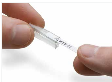
Einsteckschild in die Aufnahme einer Kennzeichnungstülle schieben. Änderungen der Beschriftung sind auch bei angeschlossenem Leiter noch nachträglich möglich.
