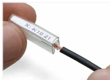
Zu kennzeichnenden Leiter durch Tülle schieben.
