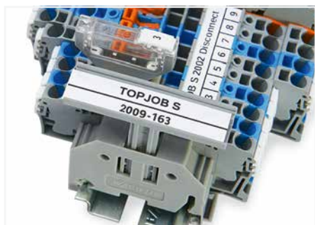
Höhenverstellbarer Gruppenschildträger (2009-163), geeignet für WMB- oder Beschriftungsstreifen (2009-110)
