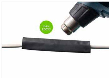
Schrumpfschlauch gleichmäßig mit einem Heißluftgebläse 110°C bis 200°C erwärmen.
