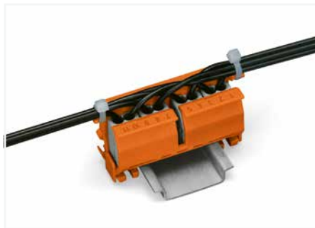
Zugentlastung durch Kabelbinder am Adapter, quer zur Klemmenanschlussrichtung; Eingespritzte Klemmstellenkennzeichnung
