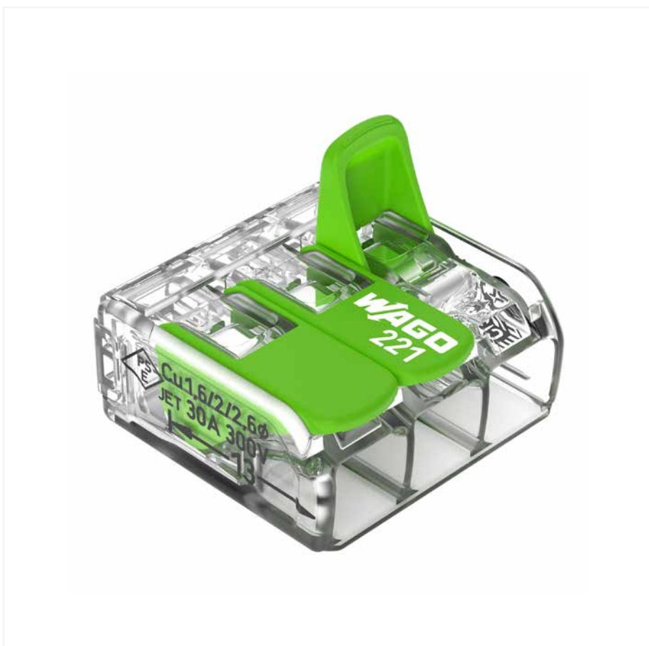
4 mm 2 : Sie klemmen bis zu 10 abisolierte, feindrähtige Leiter 0,14 ... 4 mm 2 , ein- oder mehrdrähtig 0,2 ... 4 mm 2 6 mm 2 : Sie klemmen bis zu 5 abisolierte, eindrähtige, feindrähtige oder mehrdrähtige Leiter 0,5 ... 6 mm 2 – und das ohne Werkzeug!
