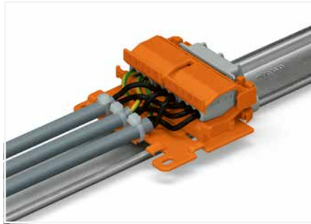
Liegende Montage mit Zugentlastungsplatte auf Tragschiene 35 mittels Universal-Winkeladapter
