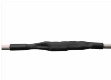
Der Schrumpfvorgang ist erst abgeschlossen, wenn der Schrumpfschlauch eng an der Leitung liegt und der Kleber sichtbar aufgeschmolzen ist. Siehe Foto.
