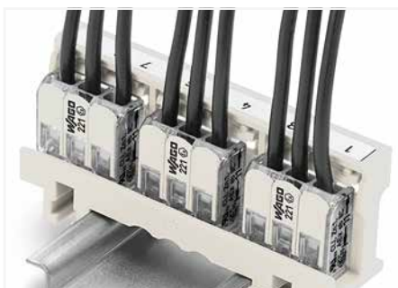
Einbauweise 440 V Senkrechte Montage auf Tragschiene 35
