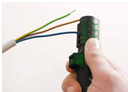
Abisolierung der Leiterisolierung
