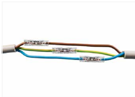
Leiter gemäß Vorgabe 10 mm abisolieren und Verbinder setzen. Beispielhafte Darstellung mit versetzten Verbindern.
