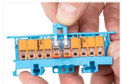
Brücker aus geöffneten Klemmstellen entfernen.
