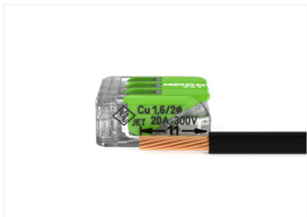
4 mm 2 : Leiter 11 mm abisolieren 6 mm 2 : Leiter 12 ... 14 mm abisolieren
