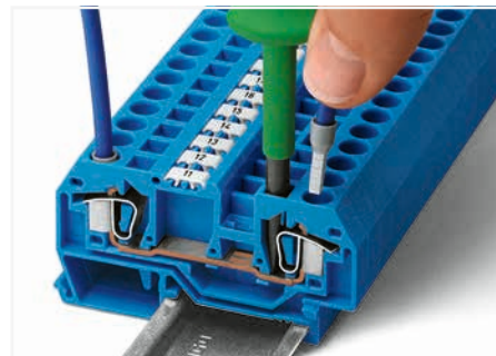
Leiter anschließen. Bei Verwendung der Nennquerschnitte mit Aderendhülsen ist jeweils die nächst größere Klemme zu wählen.
