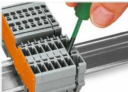
Verband mit Betätigungswerkzeug öffnen, Klemme seitlich verschieben und über Demontageschlitz lösen.
