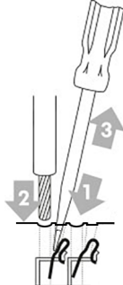
Abbildung 37: Leiter an Push-in CAGE CLAMP® anschließen
