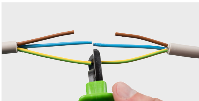
Kabel auftrennen, abmanteln und abisolieren.
