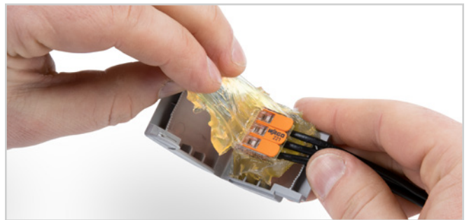
Stromkreise einfach erweitern: Gelbox öffnen, Gel von Klemme entfernen, Klemme öffnen und Leitung mit neuen Komponenten bestücken.
