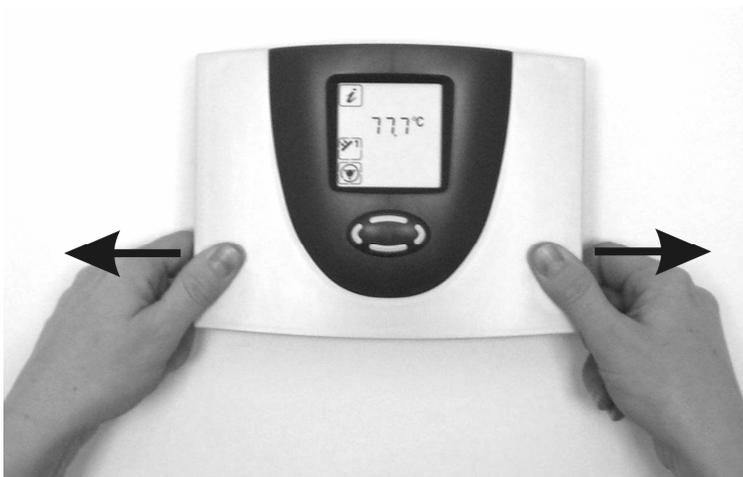
Ziehen Sie die beiden Seitenteile kräftig nach außen und klappen Sie dann das Gehäuseoberteil soweit hoch, bis dieses einrastet. Sie haben
